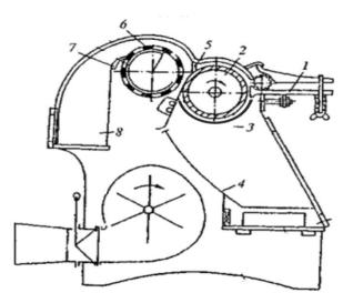
1). spare shafts.2). sawtooth drum.3). surface with a grid of new design.4). Garbage chamber.5). separating knife.6). different drums.8). purified fibre.
