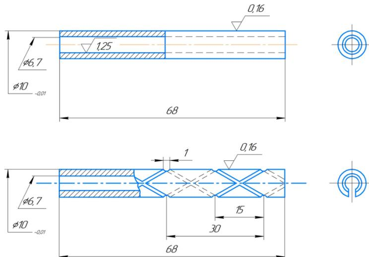
**Fig. 2. Lapping for lapping holes.**
